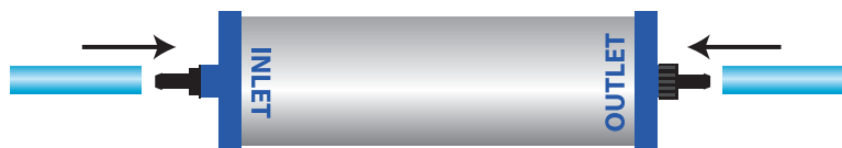
9, 将水管和过滤器连接
